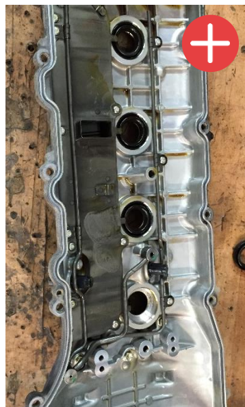
Вид клапанной крышки Toyota Sequoia в момент съема (пробег 300 000 км )
